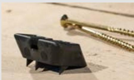
Posizionare i connettori CSC 45 PowerFast in corrispondenza della mezzeria della trave in legno rispettando il corretto passo (min/max) di dimensionamento.
