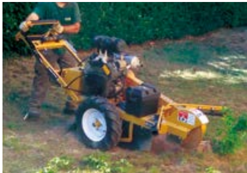
FRESACEPPI RAYCO RG 25 HP Semovente, elimina il ceppo dopo il taglio
