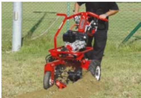
CATENARIA SEMOVENTE BARRETTO 712 Prof. scavo 35cm, per impianti di irrigazione
