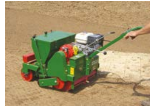
SEMINATRICE SEMBDNER RS60N Semovente semina, livella, interra e rulla
