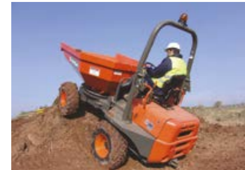
DUMPER IDROSTATICO AUSA/FIORI Portata 1500/2500 Kg
