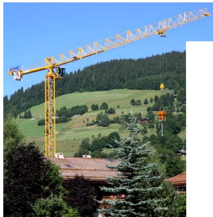
Dotate di bracci di lunghezza variabile da 55 a 65 m, le gru MDT City offrono capacità di sollevamento da 6 a 10 t.
