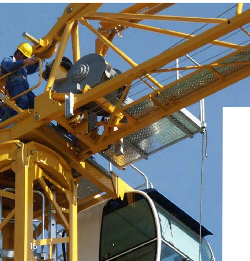
Navicella del carrello sul lato cabina per garantire la sicurezza totale del tecnico che rimane nel campo visivo del gruista. Controllo e verifica rapidi senza spostamenti sul controbraccio.
