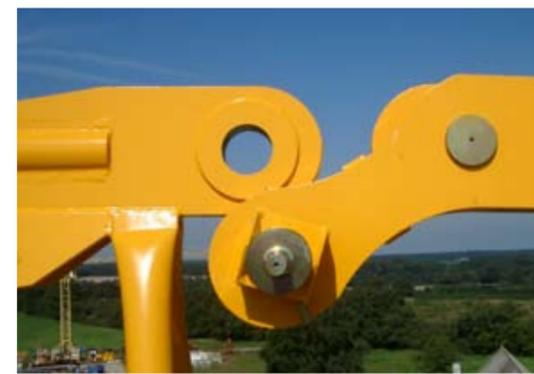
Spinatura rapida e facile per mezzo dei perni di centraggio del giunto. I perni di centraggio garantiscono la regolazione e il centraggio perfetto e automatico della struttura inferiore. Montaggio del braccio veloce grazie alle giunzioni. Elementi di braccio da 5 m.
