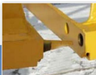
Assemblaggio del braccio per mezzo di due perni di centraggio.
