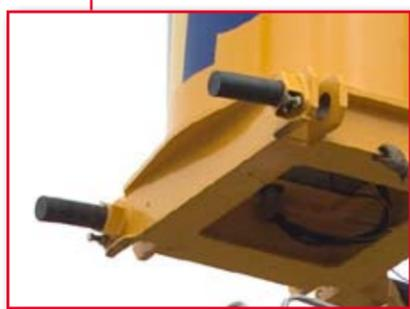
Giunzioni dell'elemento-cabina sul portaralla tramite 4 perni
