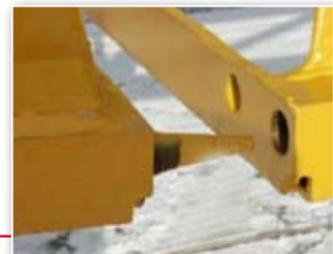
Posizionamento della struttura inferiore del braccio per mezzo di due perni di centraggio.
