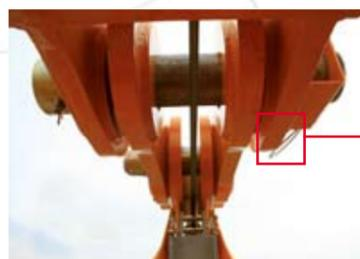
Perno sicuro con caricatore del perno e imbracatura di ritenuta.
