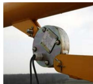
Il carico massimo è controllato da un **anello dinamometrico** situato nel portabraccio.
