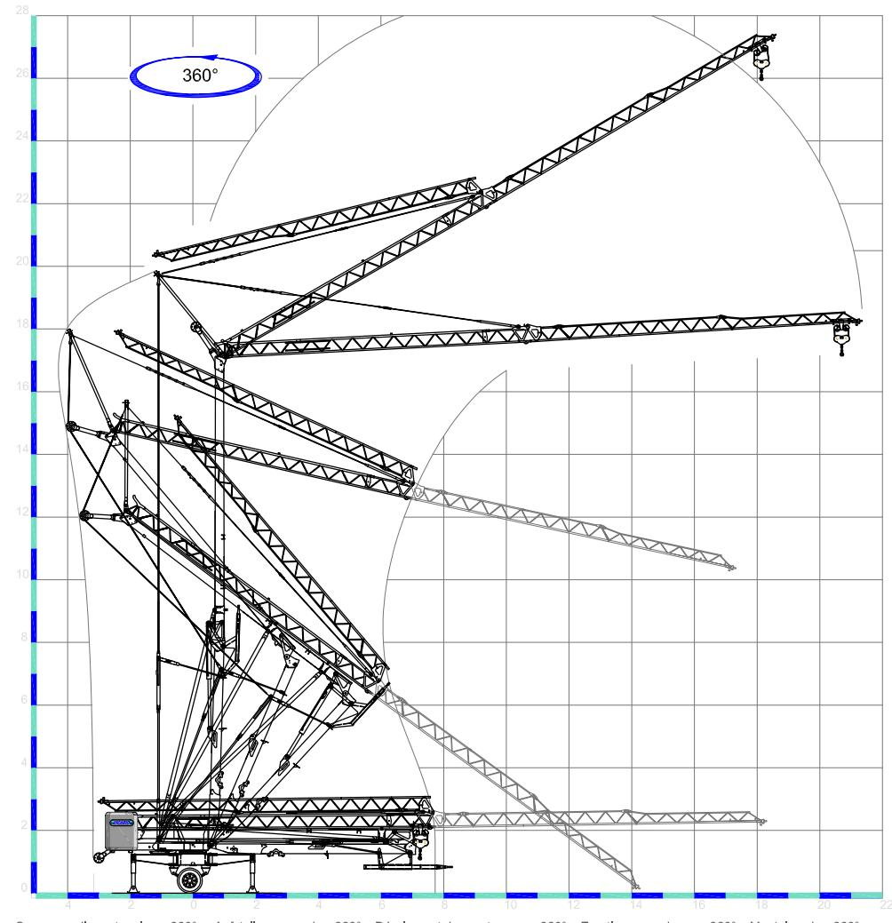
Sequenza di montaggio su 360°. Aufstellvorgang über 360°. Dérèlement de montage sur 360°. Erection procedure on 360°. Montaje sobre 360°.
